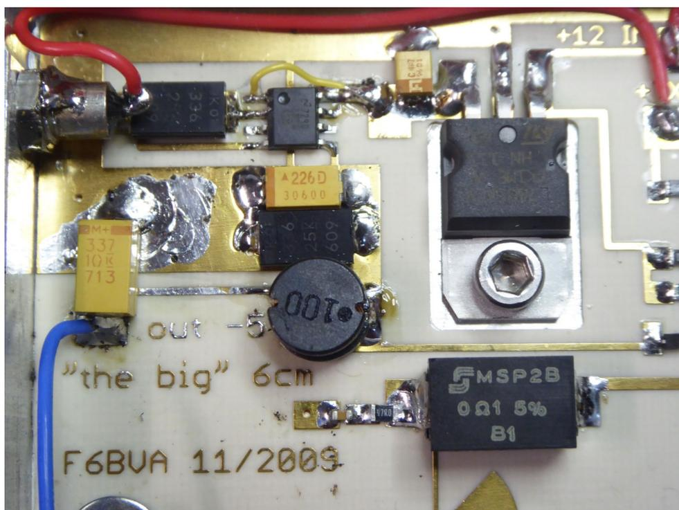
Dernier essai, le filtrage supplémentaire reste en place ( $10\mu\text{H} + 330\mu\text{F}$ ), mais pour comparaison, retour à la fréquence de découpage à 18 KHz.
