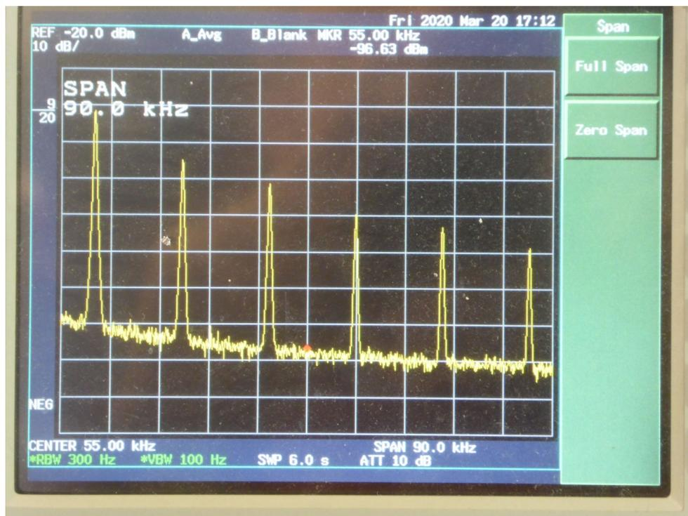
La première modification testée est de court-circuiter la patte n°1 du LM2662 avec la 8 (le 5Volts d'entrée). Cela à pour effet d'augmenter la fréquence de découpage aux alentours de 100 KHz.
