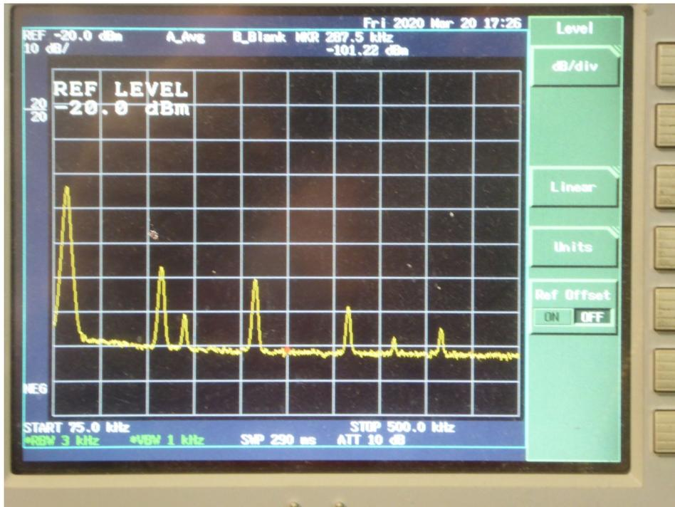
Pour la deuxième modification une cellule de filtrage en pi est ajoutée. Soit : 10 $\mu$ H en série dans le -5V suivie d'un condensateur de 10 $\mu$ F. Résultat ci dessous.
