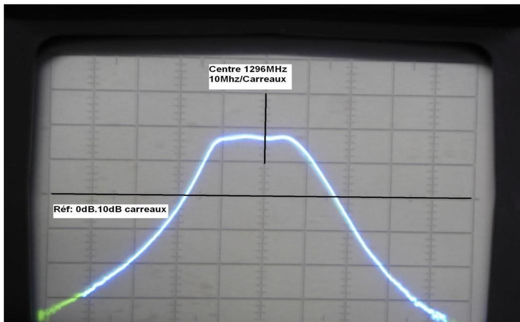
Cet ensemble Filtre + LNA est suivi dans mon cas d'un deuxième BPF (en aval). C'est est un filtre en guide en mode évanescent à 4 cellules. Voir sur ce sujet l'excellent article de W1GHZ.
